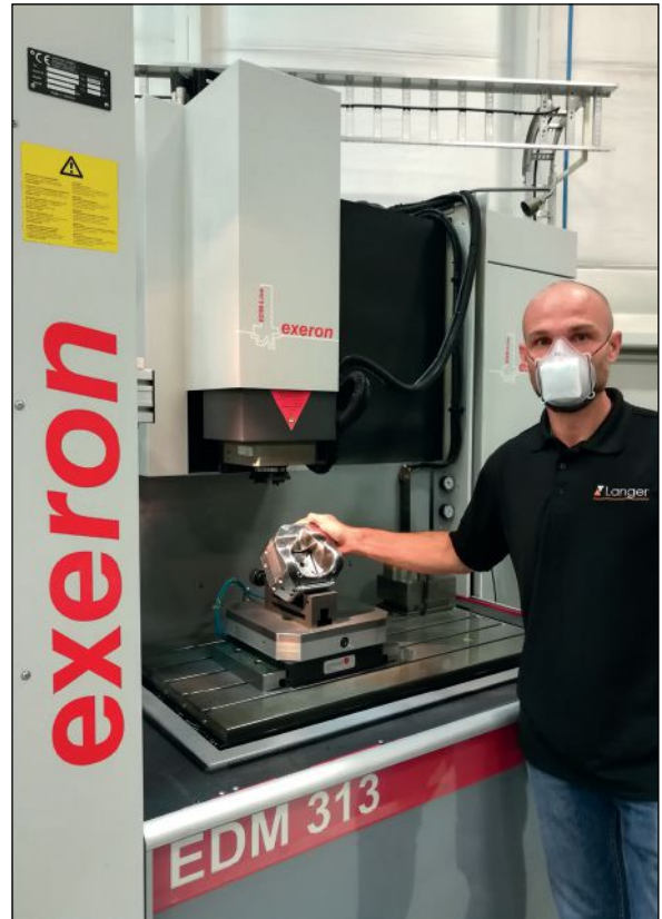
Robert Kühn muestra la cavidad del molde finalizada en una electroerosionadora Exeron.
