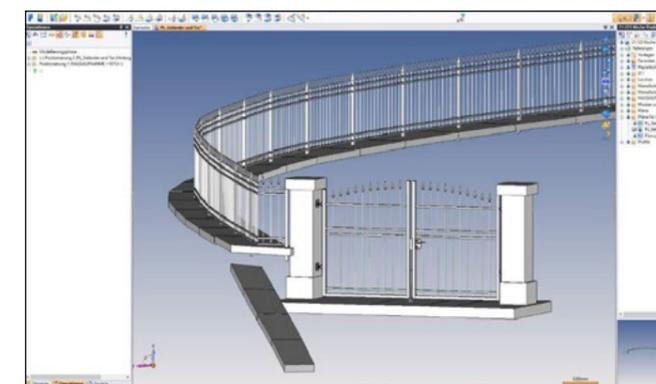
Plan mittels TopSolid'Steel Software für das Geländer der Kirche in Uesslingen
