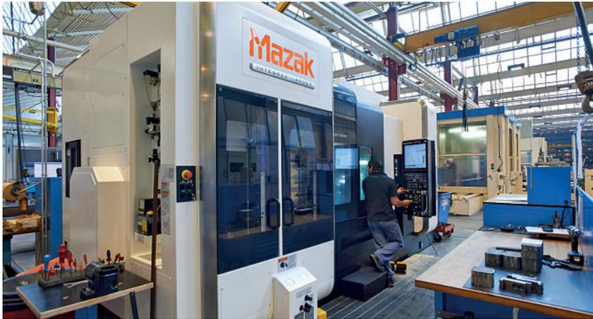
**Komplettbearbeitung auf einer Maschine: Komplexe Dreh- und Dreh-Fräsbearbeitung gehören bei der Bruderer AG zum Tagesgeschäft.** (Bild: Bruderer)
